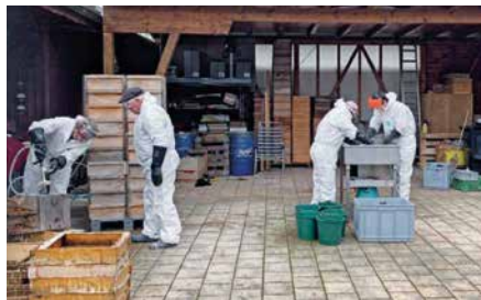
3. kép: Használatban a Méhegészségügyi Szolgálat (BGD) mobil egészségügyi egysége és felszerelése. Balról jobbra: habosító-fertőtlenítő berendezés, kézmosó kád és kaptármosó gép. (Fotó: Apiservice)
